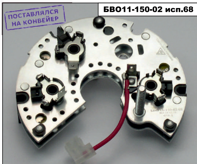
14В, 6 силовых ограничительных диодов, без дополнительных диодов, 3 втулки, вывод от фазы 30°, вывод от фазы 90°, присоединение клеммой, выходной болт М6
